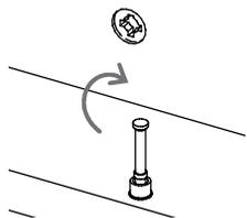
Luego de unir las piezas, debes girar 180° las cajas minifix con un destornillador de estrella para ajustar y asegurar el ensamblaje.
