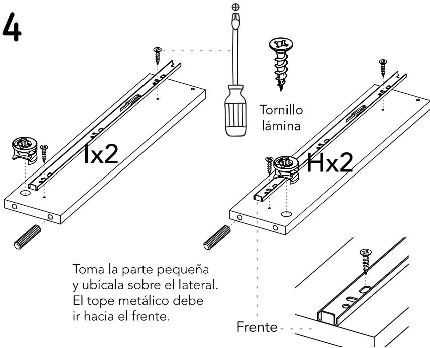
Toma la parte pequeña y ubícala sobre el lateral. El tope metálico debe ir hacia el frente.
