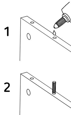
Antes de insertar cada tarugo, pon una gota de pegamento en la perforación.
