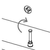
4 Luego de unir las piezas, debes girar 180° las cajas minifix con un destornillador de estrella para ajustar y asegurar el ensamble.
