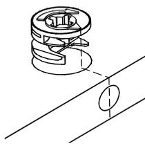
2 Debes insertar las cajas minifix con la flechita apuntando hacia la perforación que hay en el borde de la pieza.
