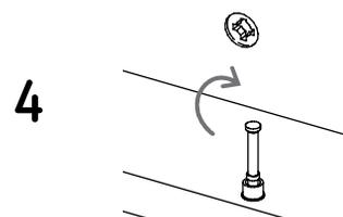
Luego de unir las piezas, debes girar 180° las cajas minifix con un destornillador de estrella para ajustar y asegurar el ensamble.
