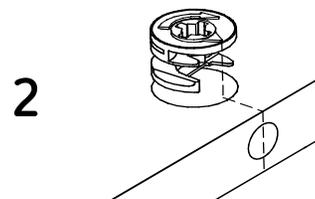
Debes insertar las cajas minifix con la flechita apuntando hacia la perforación que hay en el borde de la pieza.
