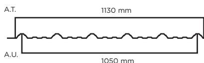
Panel Termoacústico multicapa Klar de 1.5mm de espesor con seis crestas y una altura de 28mm. Diseño que permite desarrollar mayor inercia, facilidad de montaje, flexibilidad permitiendo un radio de curvado de 6mts sin hacer uso de máquinas de rolado.
