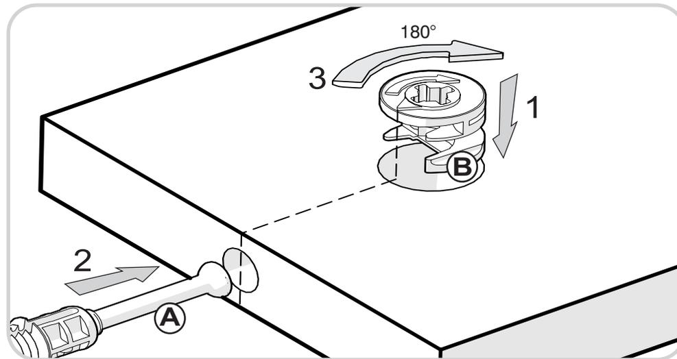
Sistema de unión compuesto por un perno (A) y una caja minifix (B).
