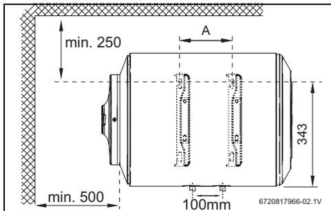
Fig. 3 Dimensiones en mm (Instalación en posición horizontal)
