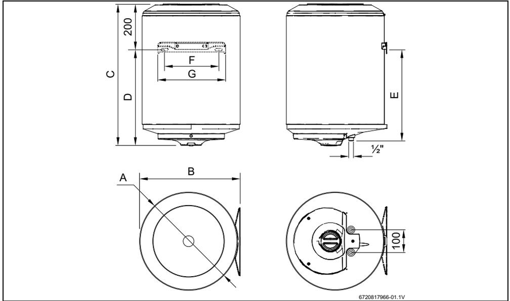
Fig. 2 Dimensiones en mm (Instalación en posición vertical)
