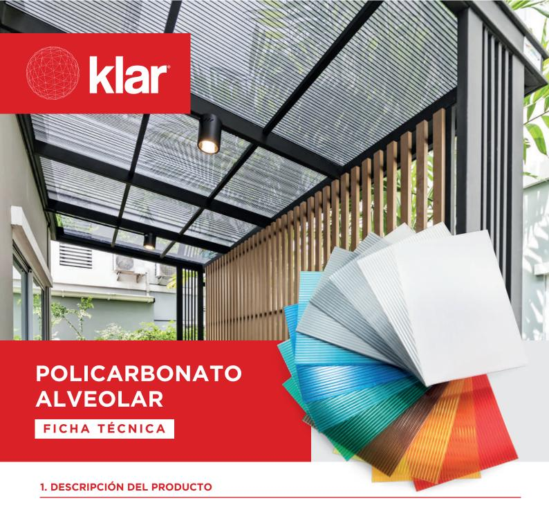
Los paneles alveolares Klar son fabricados en un proceso de extrusión con 100% resina virgen de policarbonato, colorantes y poseen una capa UV coextruida que actúa contra la radiación solar, evitando su envejecimiento acelerado. Se caracterizan por su gran resistencia al impacto, aislamiento térmico y alta transmisión de luz. Su óptima flexibilidad permite el corte a medida y curveado en frío.
