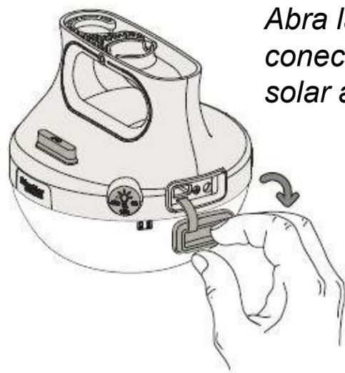
*Abra la tapa protectora y conecte el cable del panel solar a la lámpara.*
