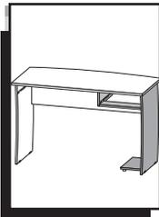
La pieza 4 puede ser instalada del lado derecho o izquierdo de la pieza 3
