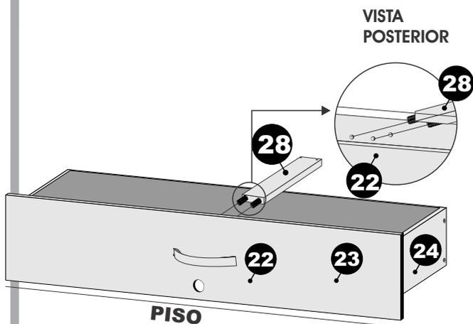
INSTALAR TORNILLOS DE LA PIEZA 28 A LA PIEZA 26
