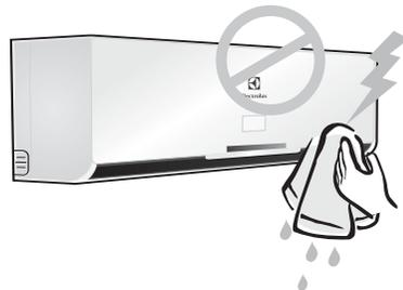
12. No limpie el acondicionador de aire con agua. El agua podría penetrar en la unidad y deteriorar su aislamiento, además de peligro de descargas eléctricas.
